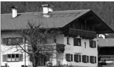
sionierung. Erfahrungswerte gehen von 1,5 bis 2 m<sup>2</sup> Kollektorfläche pro Person aus. Ratsam ist es dabei, im Vorhinein die eigenen Gewohnheiten und den Warmwasserbedarf zu erheben. Der Wasserspeicher wird meist auf den Verbrauch von zwei Tagen ausgelegt. Das sind im Vier-Personen-Haushalt etwa 400 Liter.
